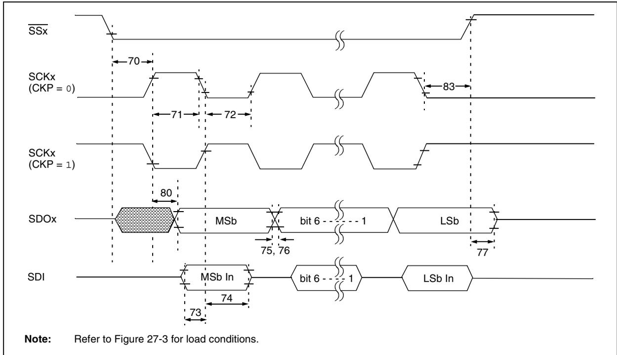
**TABLE 27-21: EXAMPLE SPI MODE REQUIREMENTS (SLAVE MODE TIMING, CKE = 0)**
