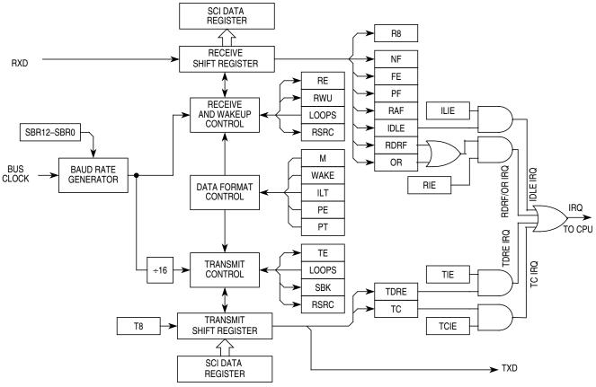
Figure 16-9. SCI Block Diagram
