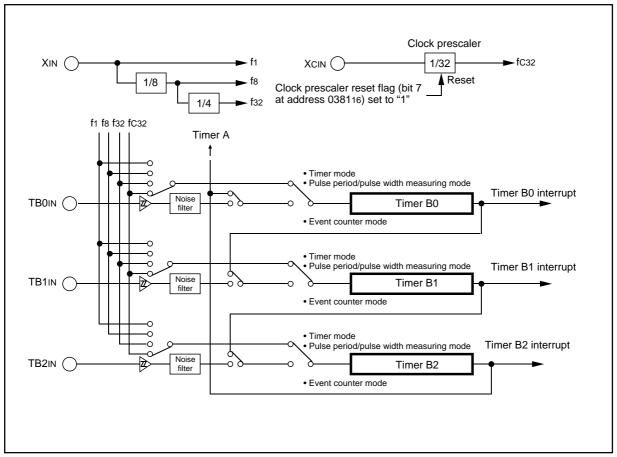
Figure 2.10.2 Timer B block diagram
