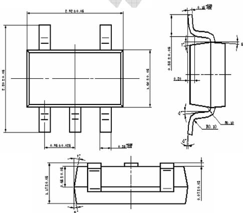
图 7 SOT23-5 封装外形尺寸图
