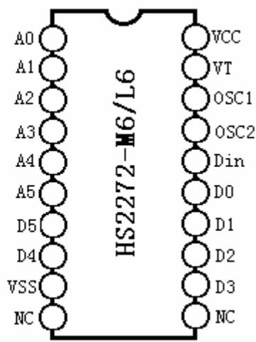
如上图所示：2272 的所有型号均能封装成 DIP18 和 SOP20 两种形式，只是 SOP20 多了 10 和 11 两个管脚，如无特殊说明，下面均为 DIP18 做说明。
