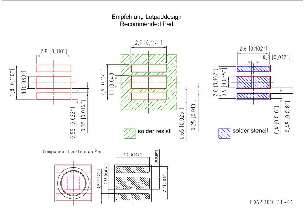
Anm.: Die Wärmesenke muss auf der Leiterplatte elektrisch gegen den Anoden- und Kathodenanschluss isoliert sein.
