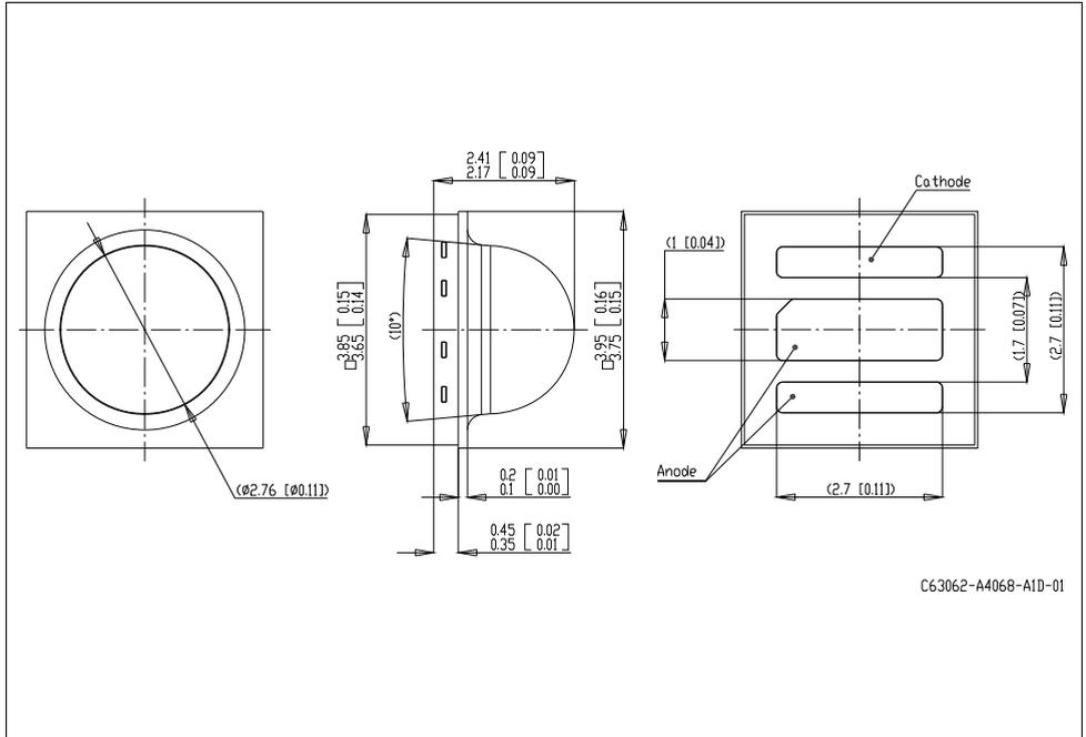
Anm.: Die LED enthält ein ESD-Bauteil, das parallel zum Chip geschaltet ist.
