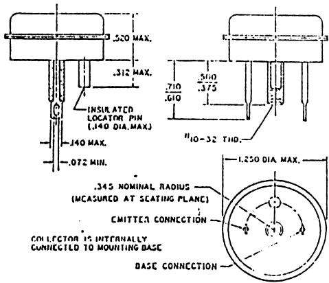
NOTE: MAXIMUM RECOMMENDED TORQUE ON THE MOUNTING STUD IS TWELVE INCH-POUNDS.
