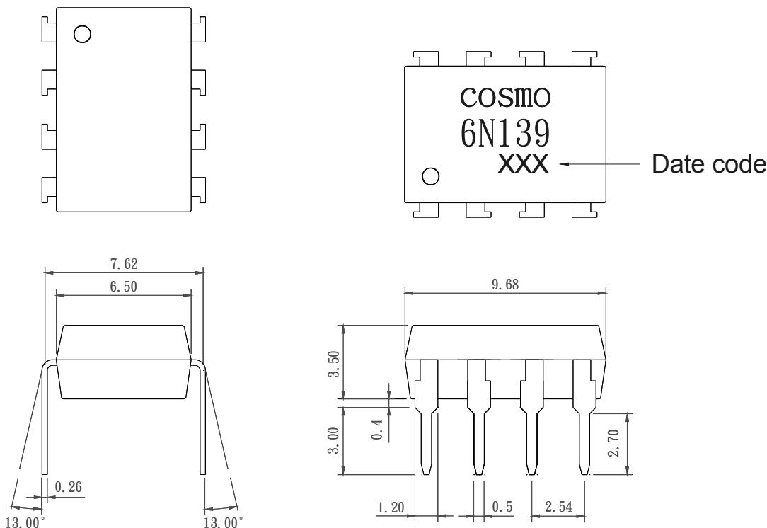
TOLERANCE :  $\pm 0.2\text{mm}$
