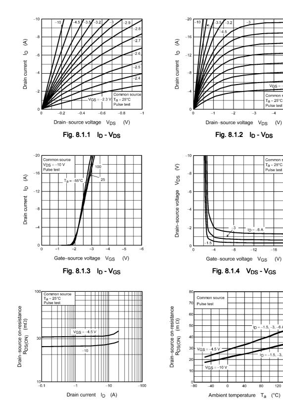
Fig. 8.1.5 R<sub>DS(ON)</sub> - I<sub>D</sub>
