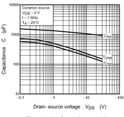
Fig. 8.1.8 Capacitance - V<sub>DS</sub>
