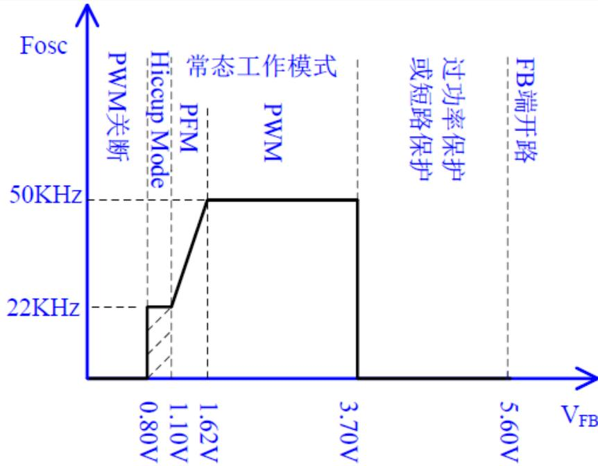
图 1.4 FB 端电压对应系统工作状态
