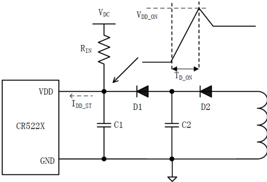
图 1.3 快速启动电路
