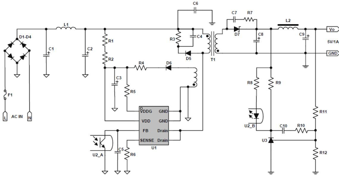
图 3.1 CR522X 典型电路原理图（通用输入）
